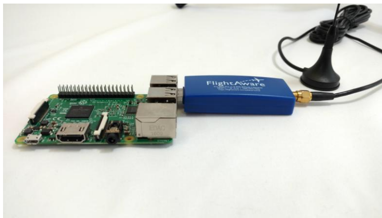
Рис. 3.6. Кабель антени у антенному USB-приймачі RTL-SDR
