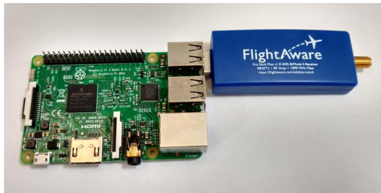
Рис. 3.5. Підключення USB-приймача SDR ADS-B до Raspberry Pi
