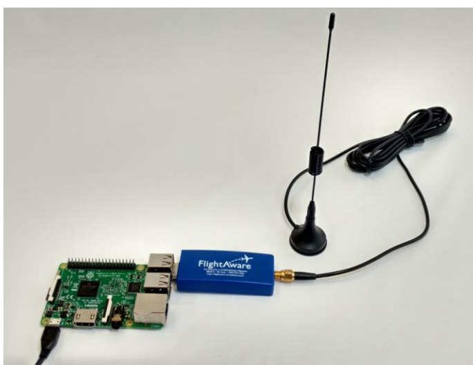
Рис. 3.7. Підключення живлення до Raspberry Pi
