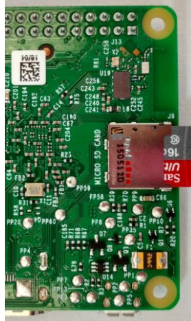
Рис. 3.4. Встановлення карти пам'яті в Raspberry Pi
