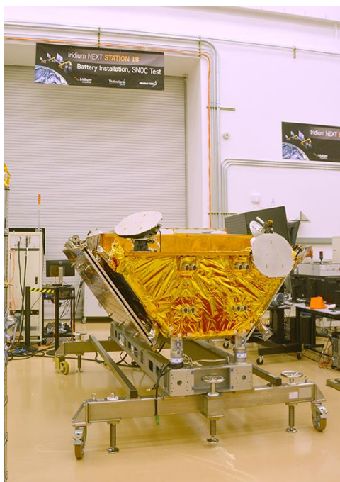
Рис. 2.5. Зібраний стек корисного вантажу Iridium-NEXT
