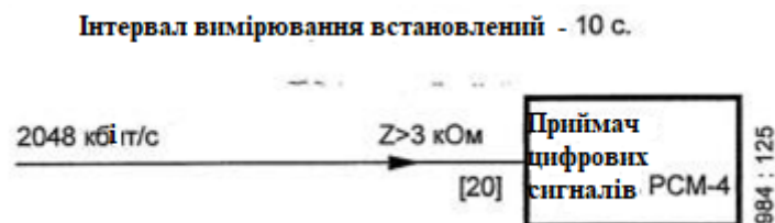
Рис. 4.6 Вимірювання помилки FAS с Z_{in} > 3 \text{ кОм}
