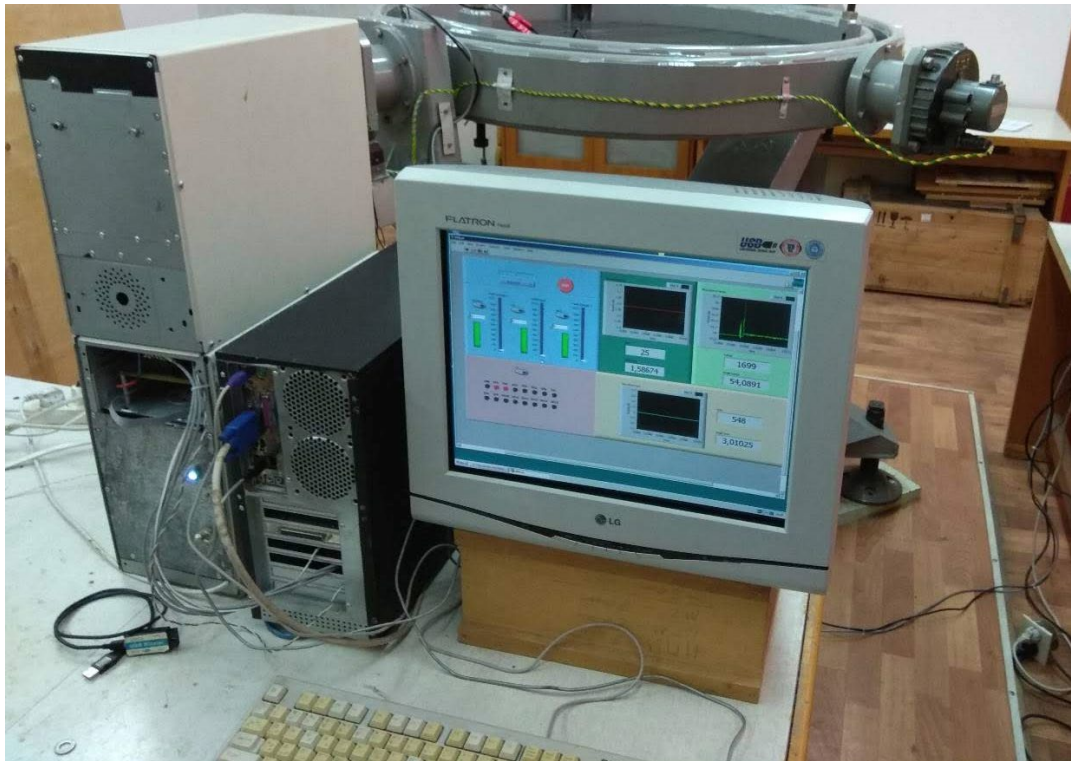
Рис. 4.15. Інтерфейс користувача та робоче місце оператора випробувального стенду. Зліва від ПК розташовані блоки керування випробувальним стендом.
