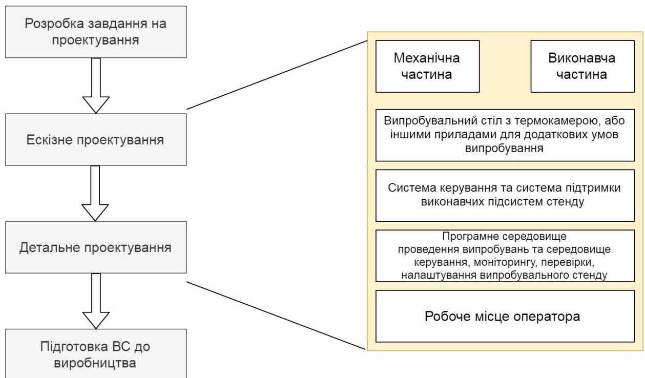
Рис. 2.1. Цикл проектування і виробництва випробувальних стендів навігаційного обладнання
