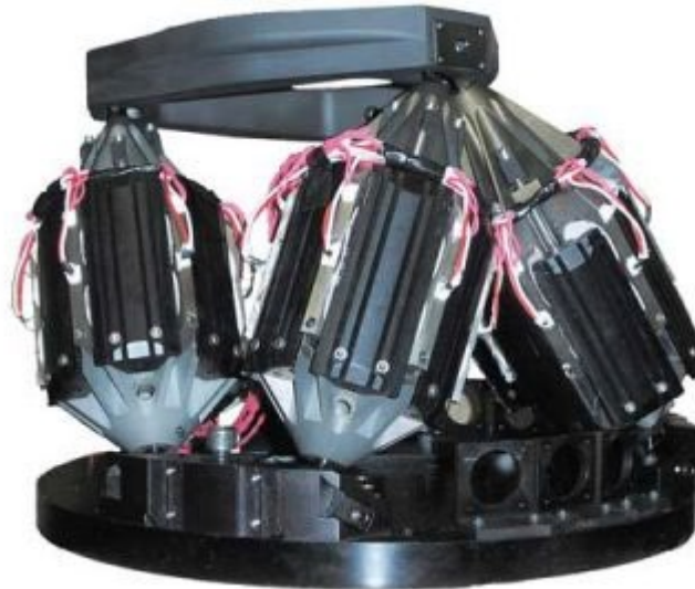
Рис. 1.9. Система динамічного випробування обладнання CARCO з шістьма ступенями свободи
