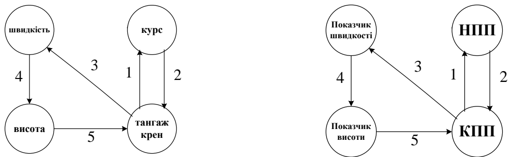
Рис.3.5 Схеми а) порядок переносу погляду Л-О при зчитуванні інформації з пілотажних приладів; б) порядок автоматичного зчитування інформації САУ з пілотажних приладів
