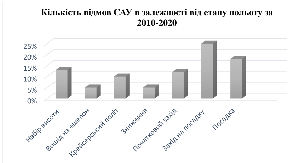
Рис.1.4. Звіт за результатами аналізу причин відмов САУ на різних етапах польоту за 2010-2020 за результатами експлуатації в наступних авіакомпаніях: АК "Росія", АК "Ангара", СЛО (спеціальний льотний загін), CUBANA de AVIACION, Air Koryo, ГАК "Україна".
