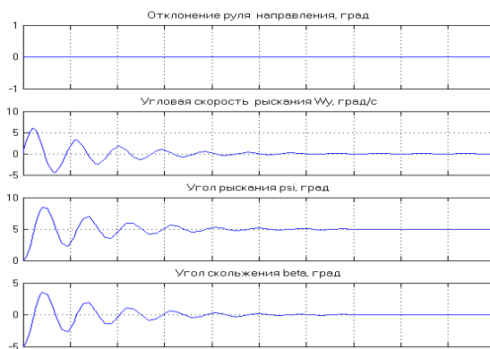
Рис.4.1. Реакція на ступінчатий порив вітру \Psi_{\text{weter}}=5 град при V_{\text{пр}}=430 км/год; H=11600 м; m=36000 кг; \alpha_{\text{fao}}=5 град
