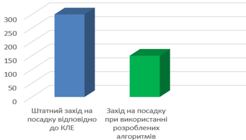
Рис. 4.56. Співвідношення витрат авіаційного палива при виконанні польотів за процедурою КЛЕ (колонка синього кольору) і при польоті з використанням розробленої інформаційної технології (колонка зеленого кольору) для етапу зниження.
