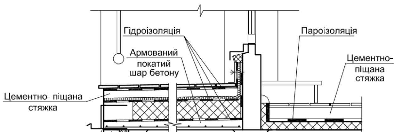
Рис. 2.10. Влаштування тераси над житловим приміщенням.
