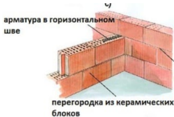
Рис. 2.7. Схема кладки керамічних блоків
