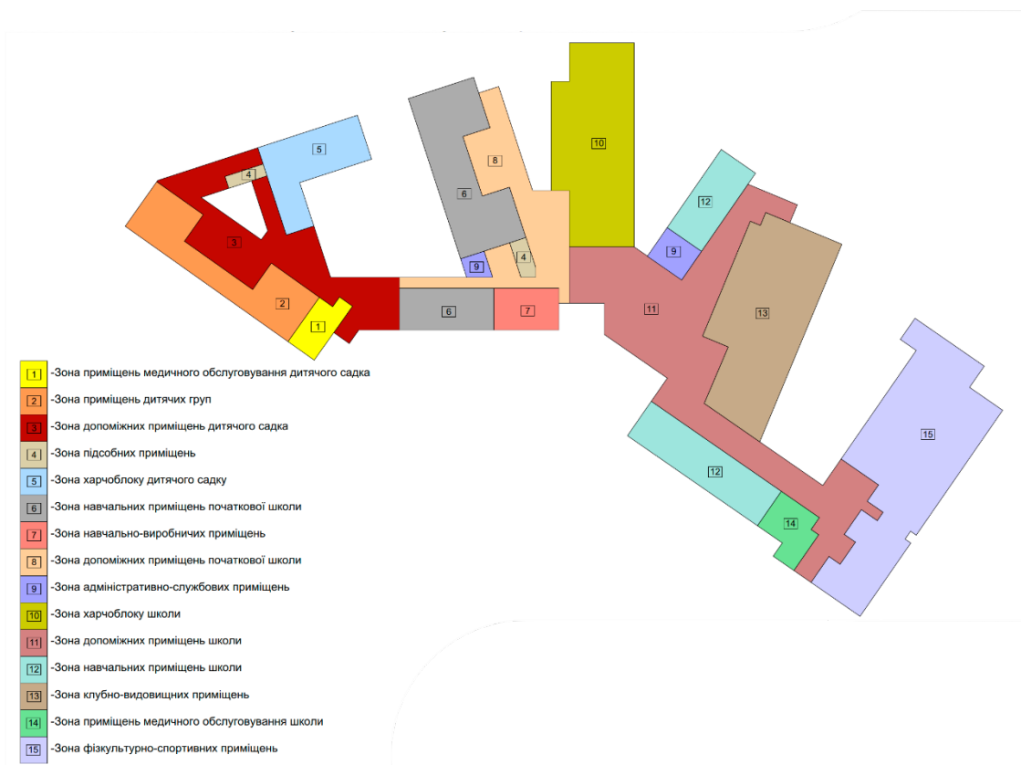
Рис. Б.1.3. Функціональне зонування приміщень на відмітці 0.000
