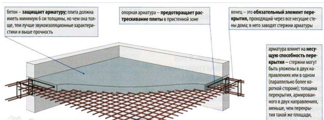
Рис. 2.9. Схема влаштування монолітного переkritтя
