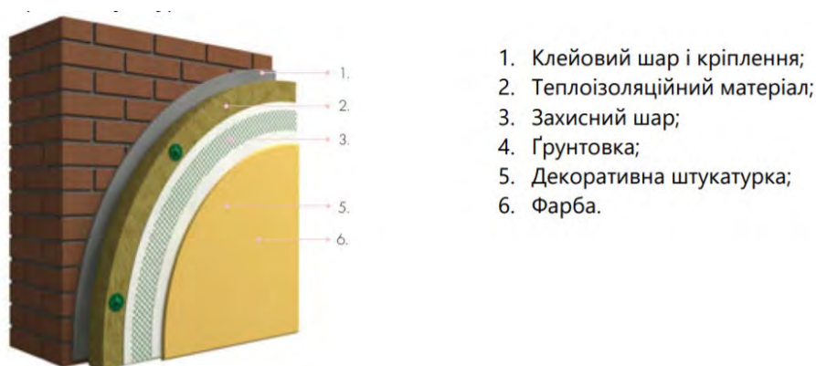
Рис. 2.4. Конструкція зовнішньої стіни
