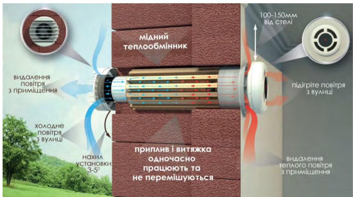
Рис. 2.6. Принцип роботи вентиляційного рекуператора
