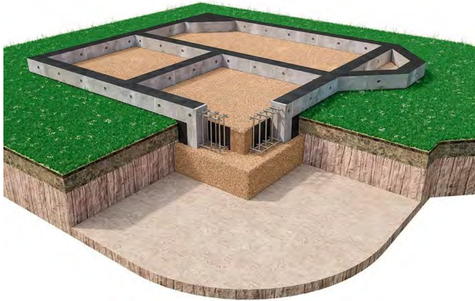
Рис. 2.2. Зовнішній вид стрічкового фундаменту
