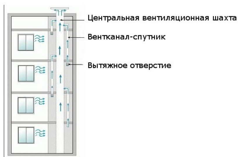
Рис.5.14. Схема витяжної вентиляції багатоповерхового житлового будинку
