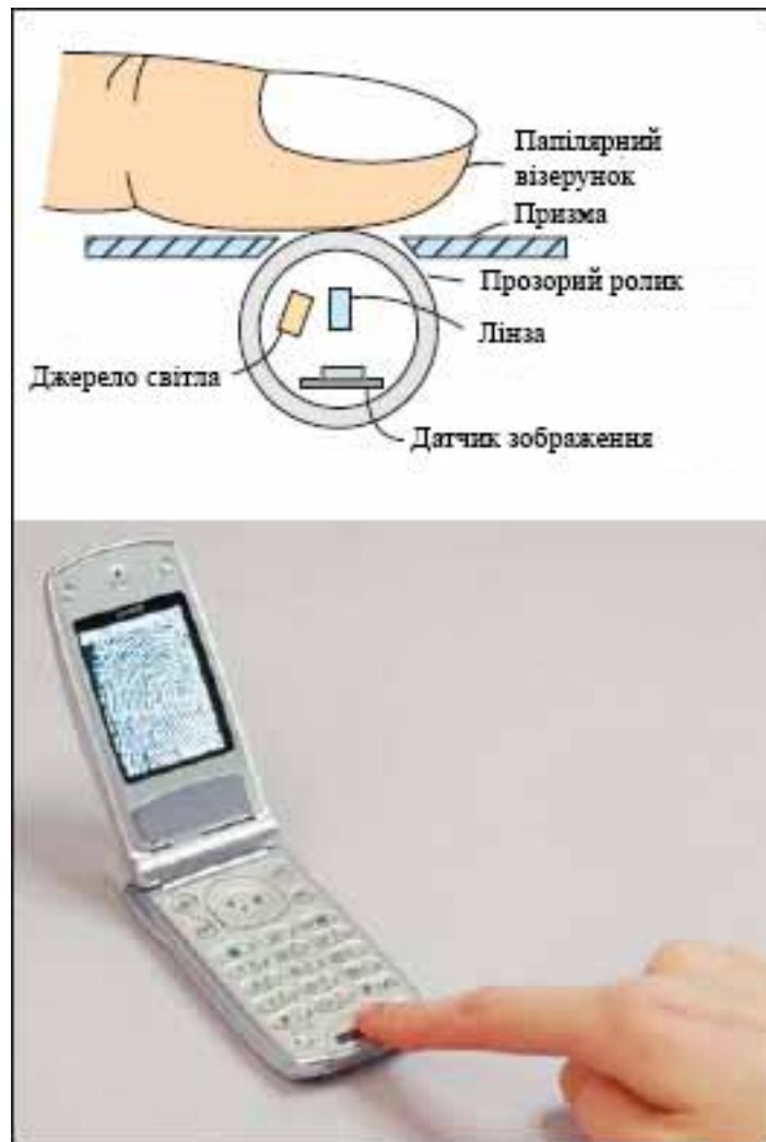
Рис.2.5. Принцип роботи роликового сканера
