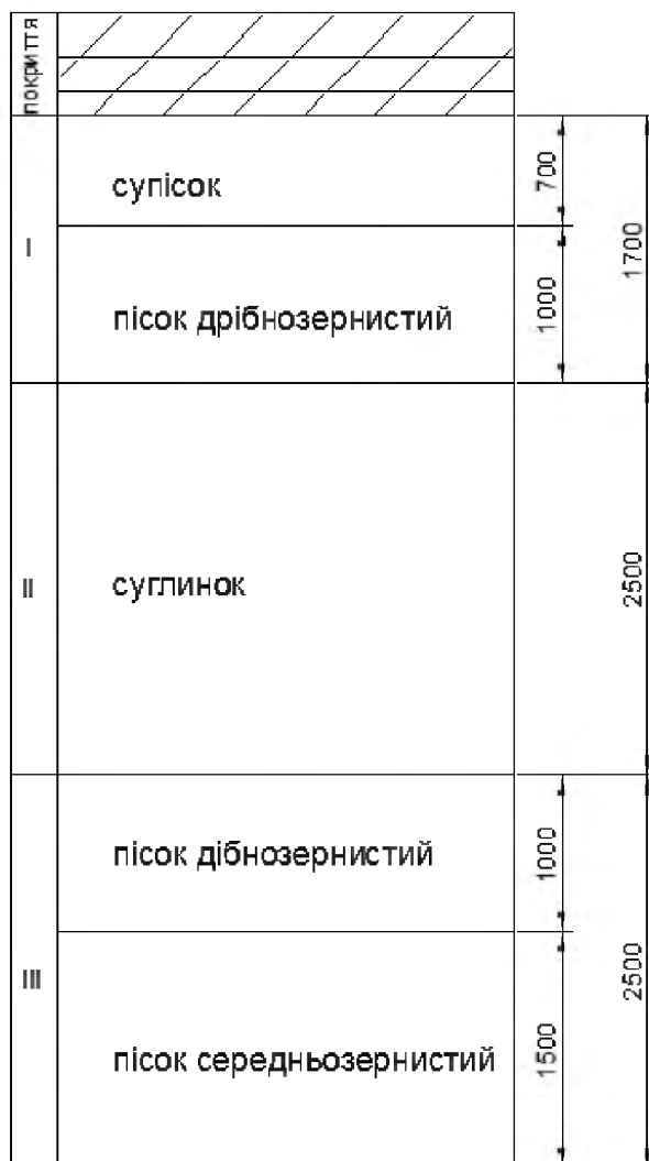
Рис. 2.1 Зведений геологічний розріз
