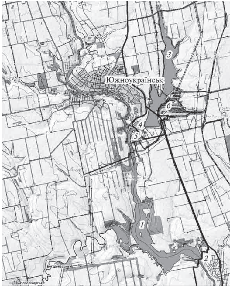
Рис. 11.2. Схема Південно-Українського енергокомплексу: 1 — Олександрівське водосховище; 2 — Олександрівська ГЕС; 3 — Ташлицьке водосховище; 4 — верхова водойма Ташлицької ГАЕС; 5 — Ташлицька ГАЕС; 6 — Південно-Українська АЕС
