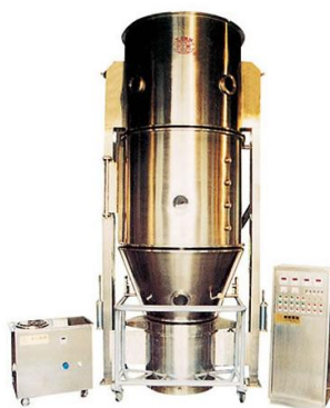
Рис. 1.2. Гранулятор із псевдозрідженим шаром
