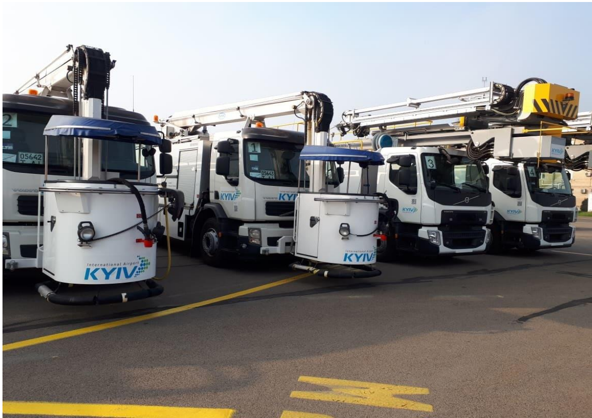
Рис. 1.15 Техніка для обробки літаків рідиною від ожеледі
