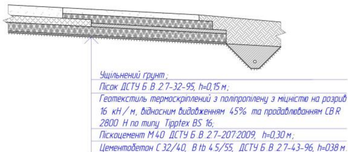
Рис. 5.3. Конструкція покриття укріплених узбіч
