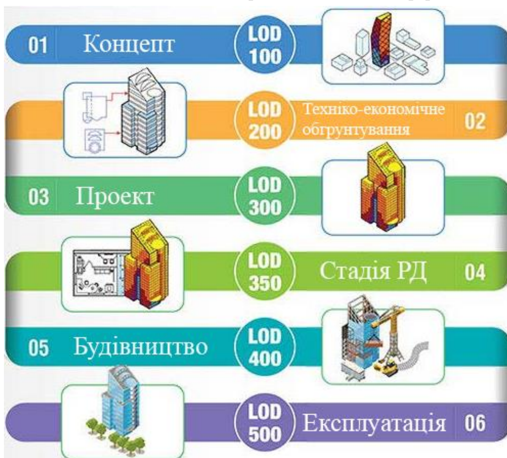
Рис. 1. Рівень деталізації BIM моделі та стадії проектування [1]
