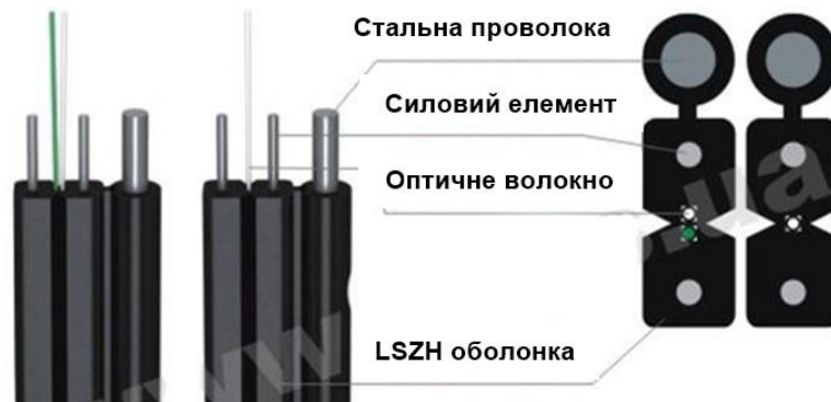
Рис. 3.4. Структура волоконно-оптичного кабелю
