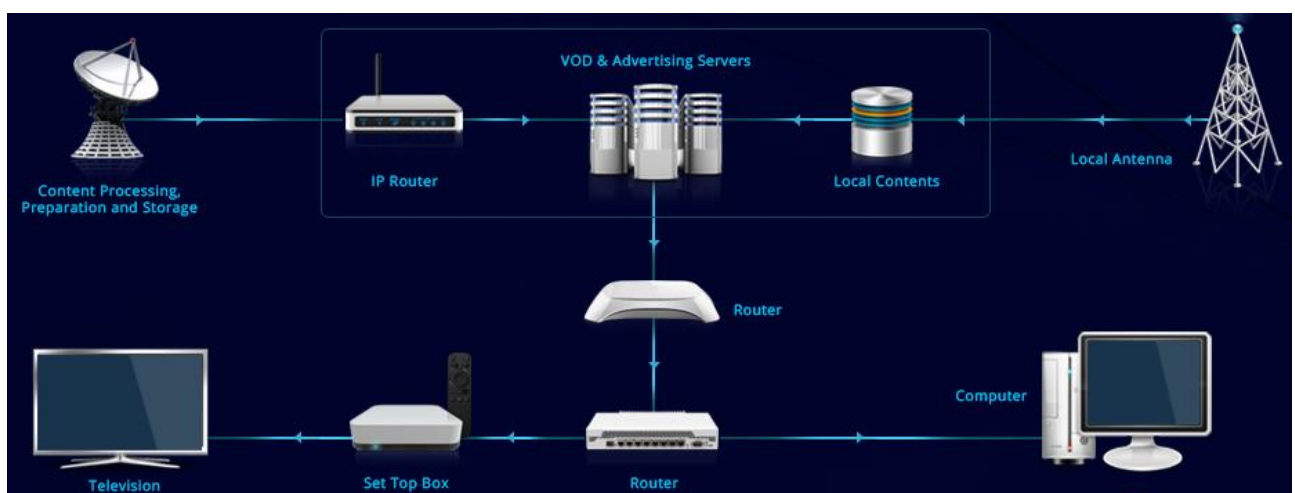
Рис. 1.2. Архітектура IPTV у загальному вигляді
