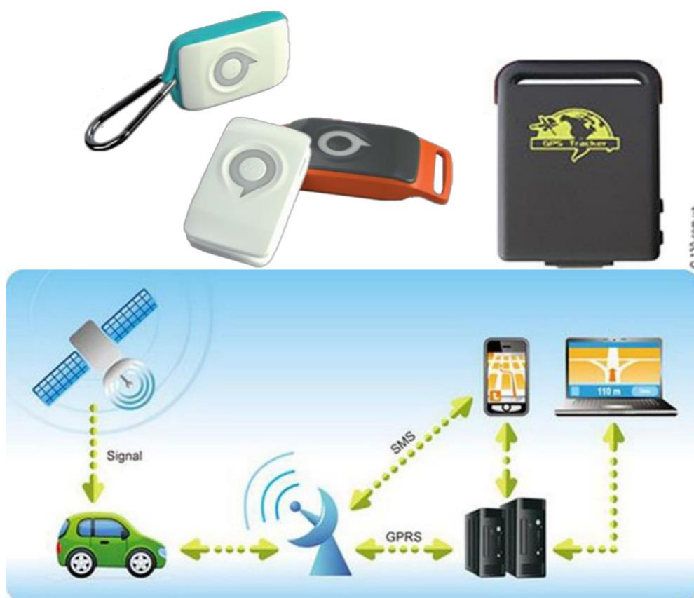
Рис. 2.5. GPS трекер та принцип його роботи
