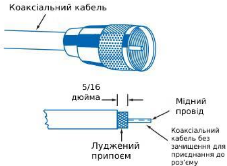
Рис. 1.9. UHF конектор PL-259
