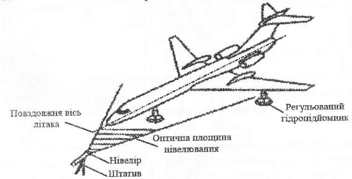
Рис. 1.12. Загальна схема нівелювання планера літака оптичним нівеліром
