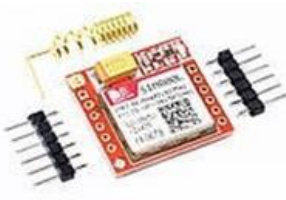
Рис. 3.7. GSM/GPRS модуль (SIM800L)
