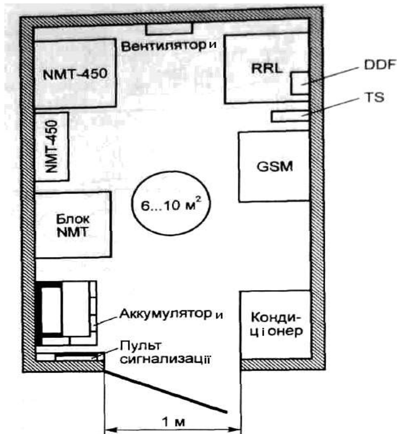
Рис. 3.6. Внутрішнє компонування апаратур GSM і NMT-450 в апаратному контейнері зв'язку BTS
