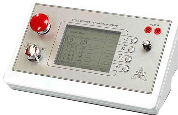
Рис. 1.4 Стенд для проведення приймально здавальних і експлуатаційних електричних випробувань засобів захисту, які використовуються в електроустановках
