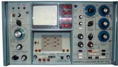
Рис. 1.11 Блок для контролю стану силових і вимірювальних малогабаритних трансформаторів
