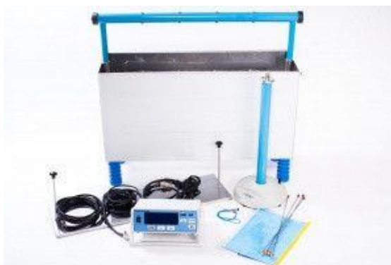
Рис. 1.8 Установа для вимірювання напруги змінного струму синусоїдальної форми частотою 50 Гц і струмів витоку при випробуваннях засобів захисту, які використовуються в електроустановках
