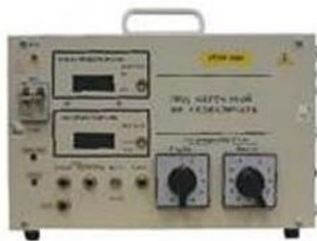
Рис.1.12. Пристрій для перевірки характеристик електромагнітних, теплових імпульсів.
