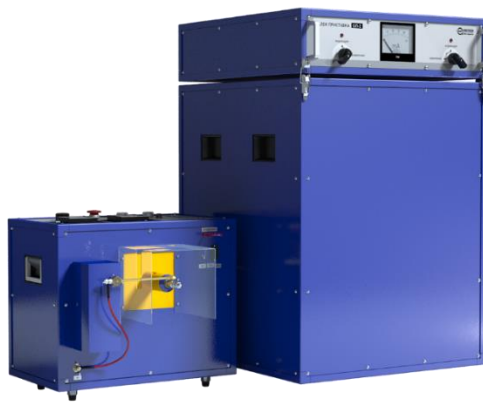
Рис. 1.3 Установка для проведення випробувань засобів індивідуального захисту при роботі з високовольтною напругою
