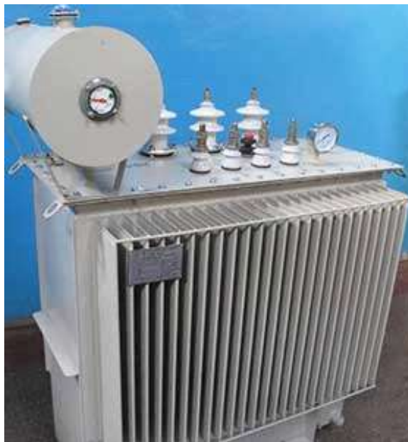
Рисунок 1.1 – Фото трансформатора ТМФ-400/10/0,4 У1
