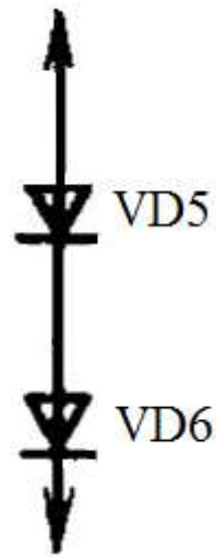
Рис. 3.5. Варіант діодно-резисторної схеми стабілізації струму спокою транзисторів кінцевого каскаду.
