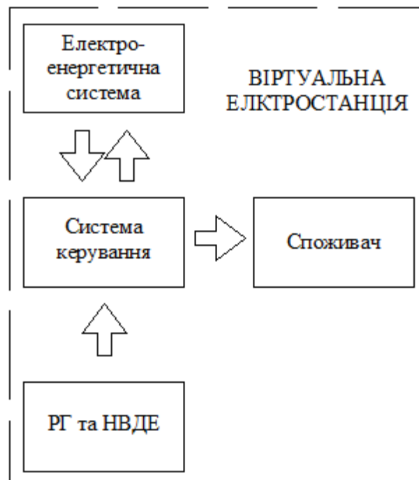
Рис. 1.3. Приклад структури віртуальної електростанції
