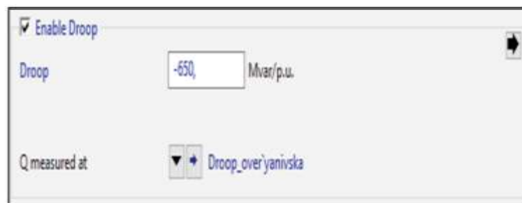
Рис 4.11. Налаштування «статизму» в ПЗ PowerFactory
