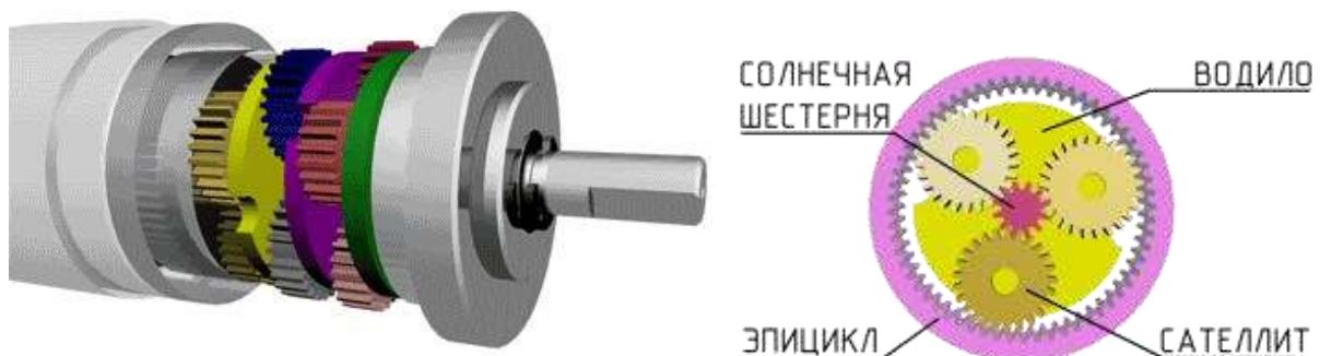
Рисунок 3.1 – Планетарний редуктор.
