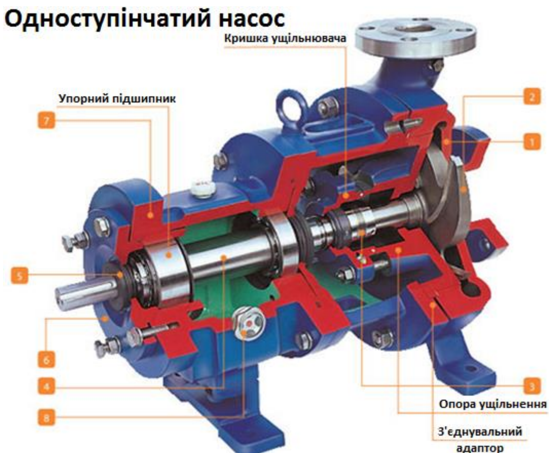
Рисунок 1.5. Креслення (типова схема) одноступінчатих відцентрових насосів
