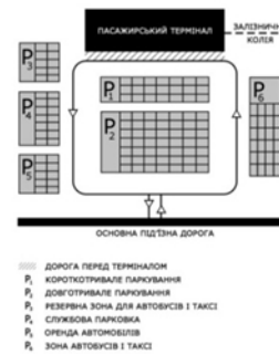
Рисунок 1. Принципова схема планування ПП аеропорту
