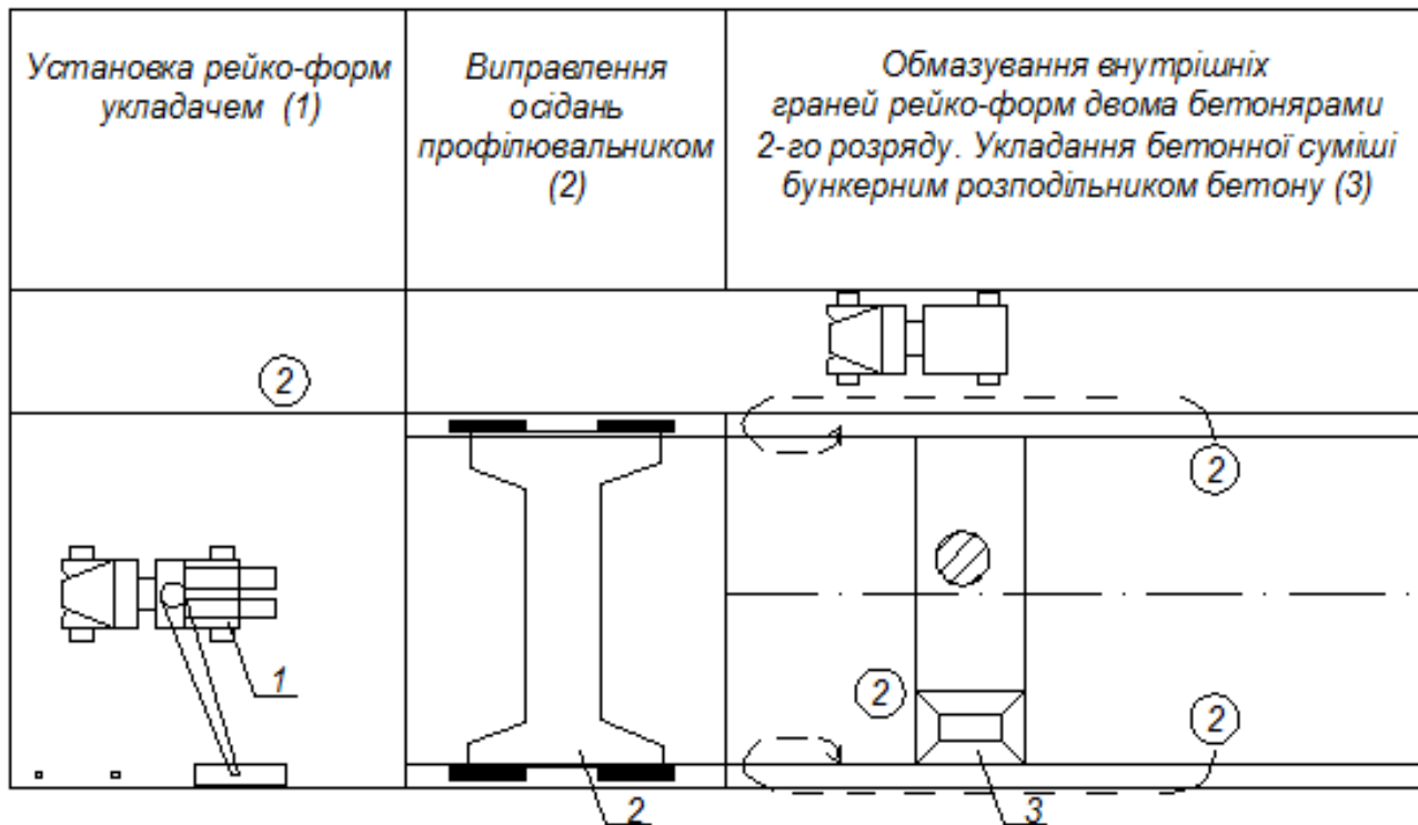
Рис. 7.13. Технологічна схема влаштування цементобетонного аеродромного покриття (початок)
