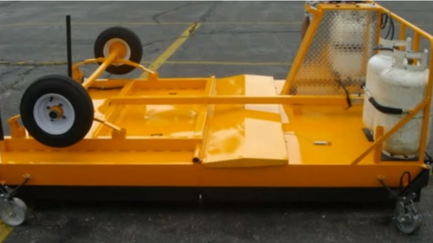
Рис. 13.4. Розігрівач для інфрачервоного нагрівання асфальтобетонного аеродромного покриття
