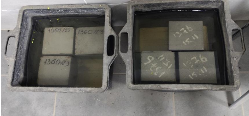
Рис. 2.44. Бетонні кубічні зразки (150×150 мм), які розміщені у воді для тверднення
