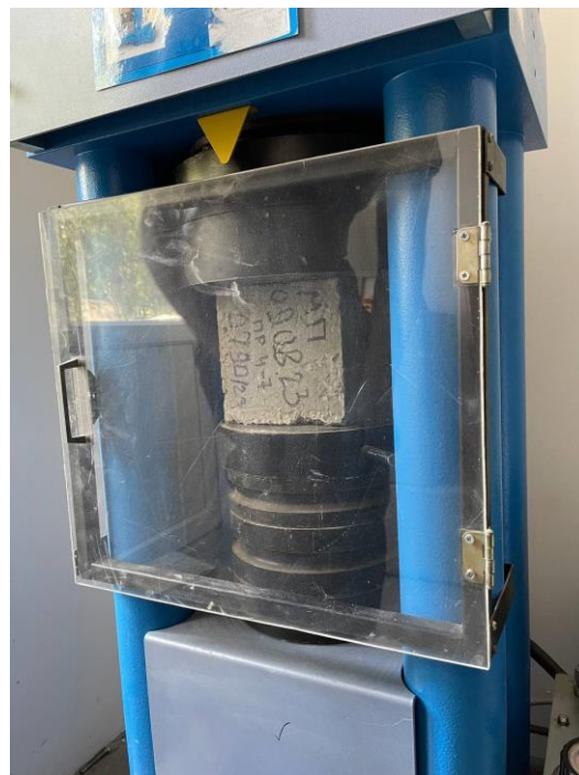
Рис. 2.47. Розміщення зразка на нижній опорній плиті преса за зачиненою дверцею Шкалу вимірювача сили випробувальної машини, преса або випробувального
