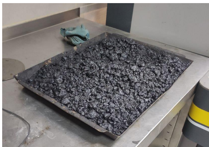
Рис.2.31. Лоток із асфальтобетонною сумішшю
