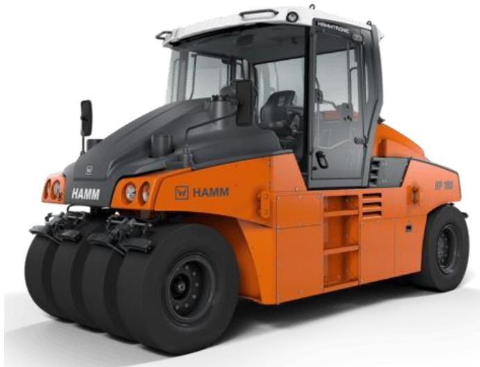
Рис.8.7. Коток самохідний на пневмоколісному ході НАММ HP 180
