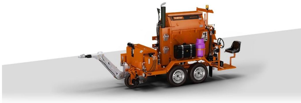
Рис. 8.4. Машина плавильно-заливальна Strassmayr RWK 600/500
