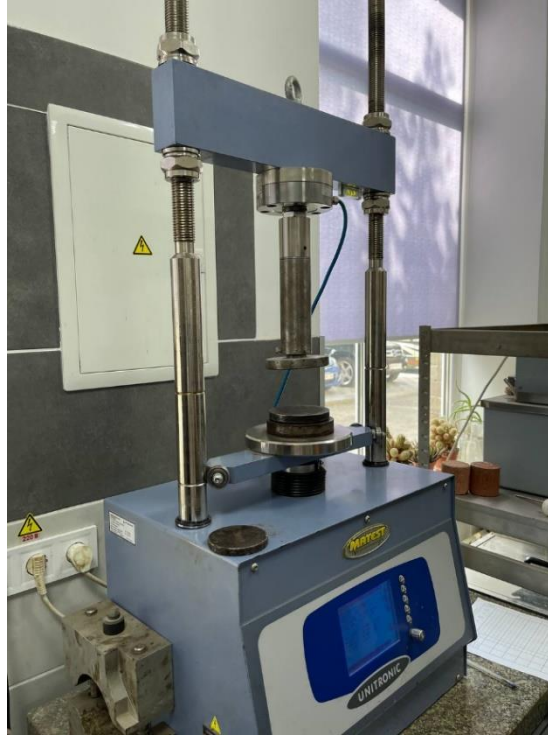
Рис.2.24. Випробувальний прес Matest S205
