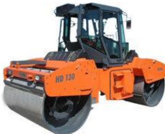
Рис.8.8. Коток дорожній самохідний вібраційний гладковальцевий НАММ HD 130
