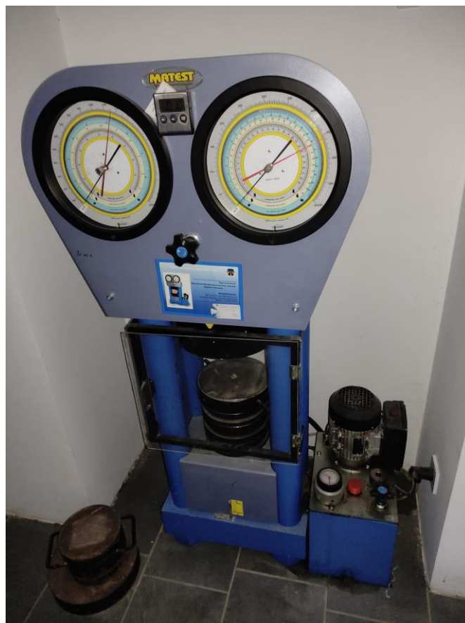
Рис. 2.45. Випробувальний прес Matest (2000 кН)
