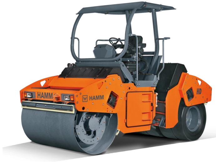
Рис.8.6. Коток дорожній самохідний вібраційний гладковальцевий НАММ HD 110
