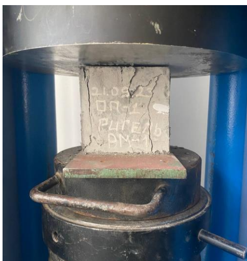
Рис.2.49. Приклад руйнування бетонного зразка при випробуванні на стиск – зразок I
