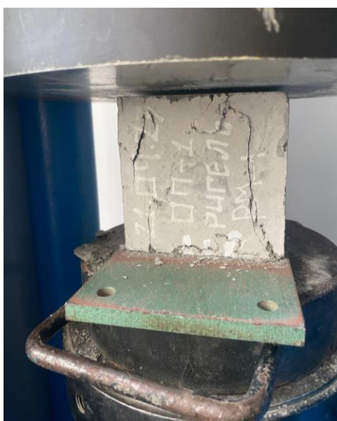
Рис.2.51. Приклад руйнування бетонного зразка при випробуванні на стиск – зразок III
