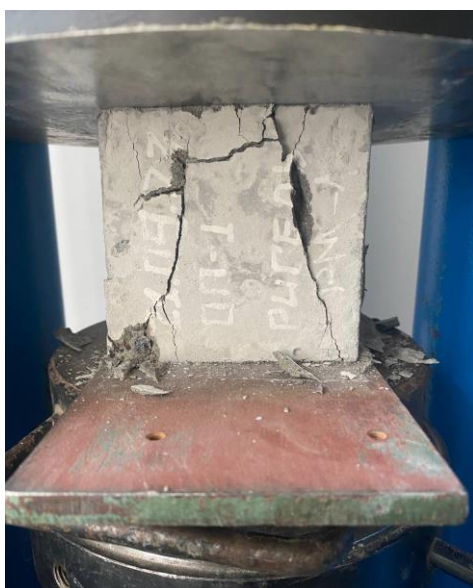
Рис.2.50. Приклад руйнування бетонного зразка при випробуванні на стиск – зразок II
