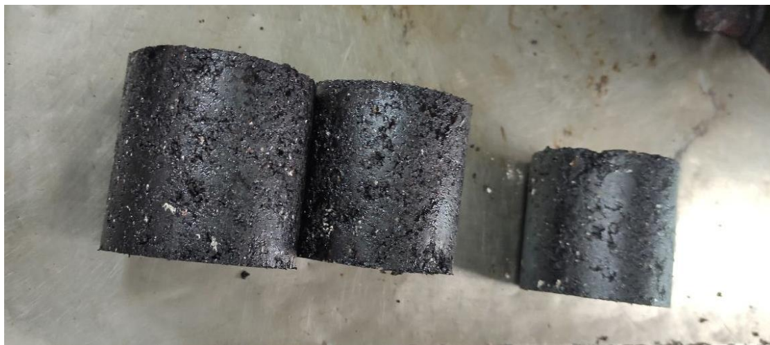
Рис.2.23. Виготовлені асфальтобетонні зразки
