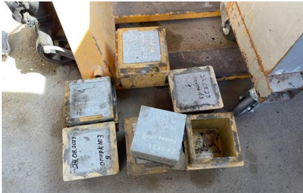
Рис. 2.43. Пластикові форми в яких розміщені бетонні зразки які готові до розпалубки
