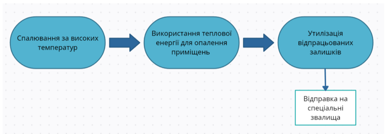
Рис. 3.5 Утилізація відпрацьованого сорбенту методом спалювання
