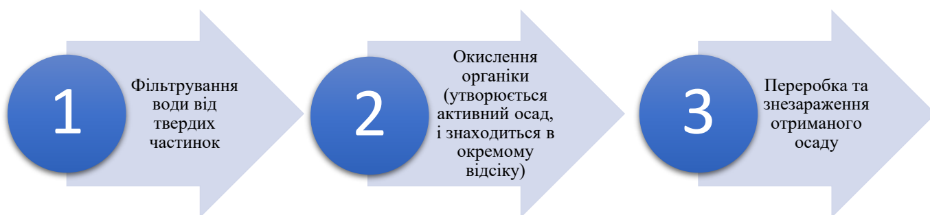
Рис. 2.8 Схема аеробного процесу очищення
