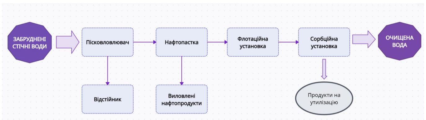
Рис. 3.1 Модернізована технологічна схема очищення оборотної води від нафтопродуктів з використанням сорбції
