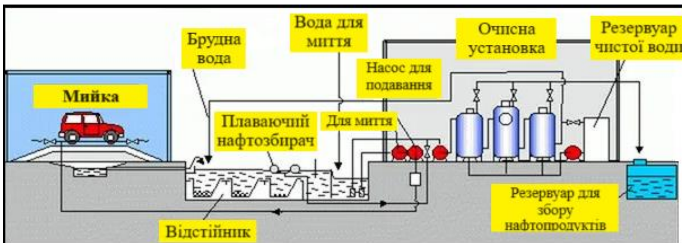
Рис. 3.2 Схема очищення стічної води автомийок для забезпечення оборотного водоспоживання
