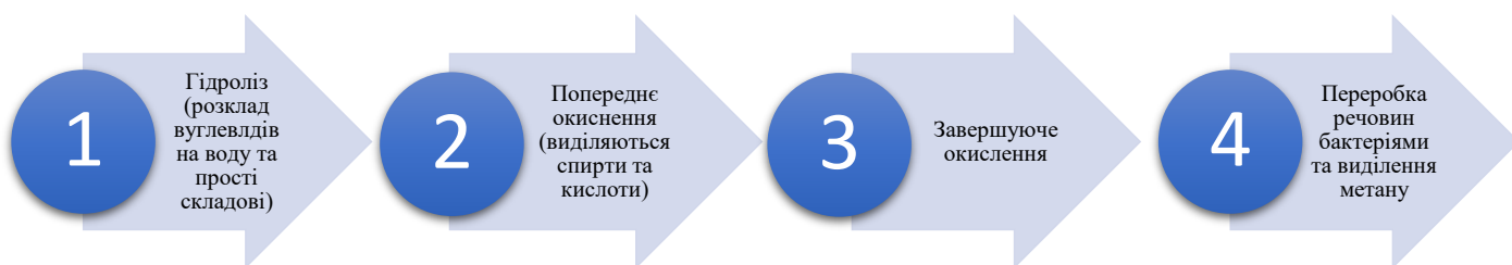
Рис. 2.9 Схема анаеробного процесу очищення
