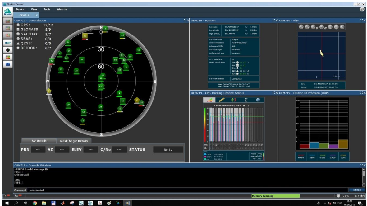
Рисунок 3.4 Чотири супутникові системи (коло - GPS, прямокутники - ГЛОНАСС, ромби - GALILEO, п'ятикутники - BeiDou)
