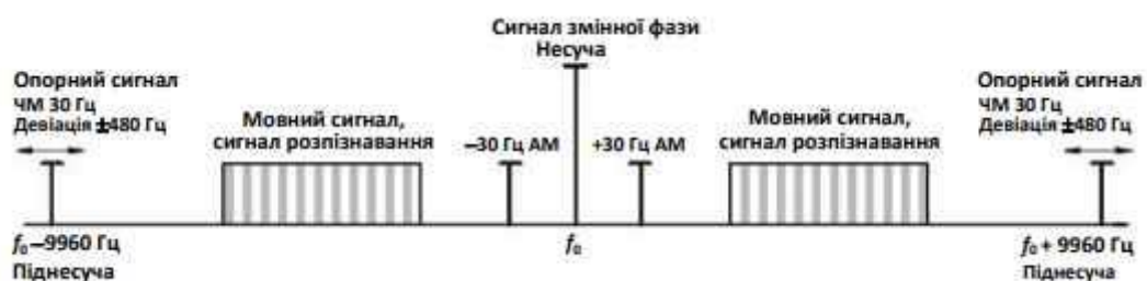
Рис 1.4. Частотний спектр сигналу радіомаяка VOR
