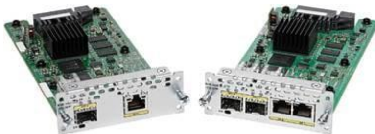
Рис. 3.3. 1-портовий та 2-портовий модуль мережевого інтерфейсу Cisco
