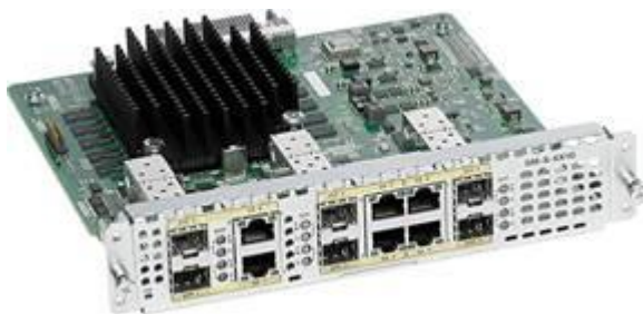
Рис. 3.4. Службовий модуль Cisco
