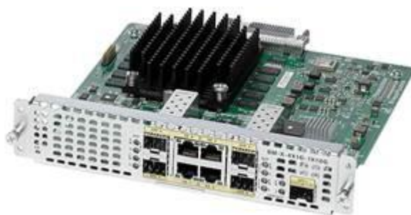
Рис. 3.5. Модуль Cisco з підтримкою SFP+
