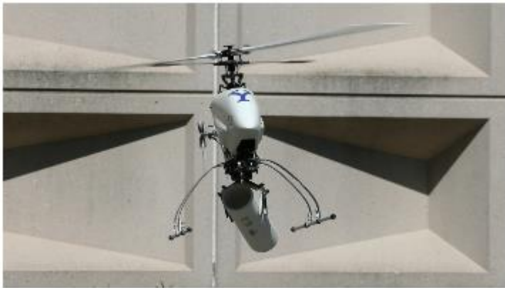
Рис. 1. Повітряний випробувальний стенд, що перенасить вантаж
