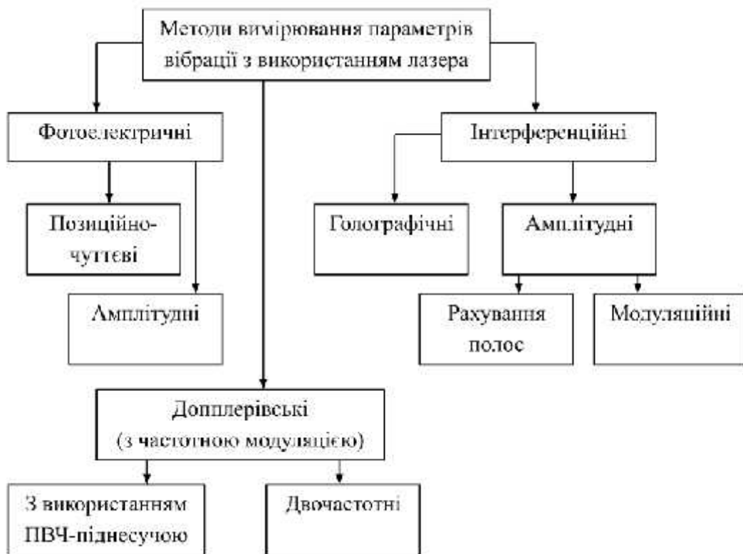
Рис. 2.7. Класифікація методів вимірювання параметрів вібрації з використанням лазера.
