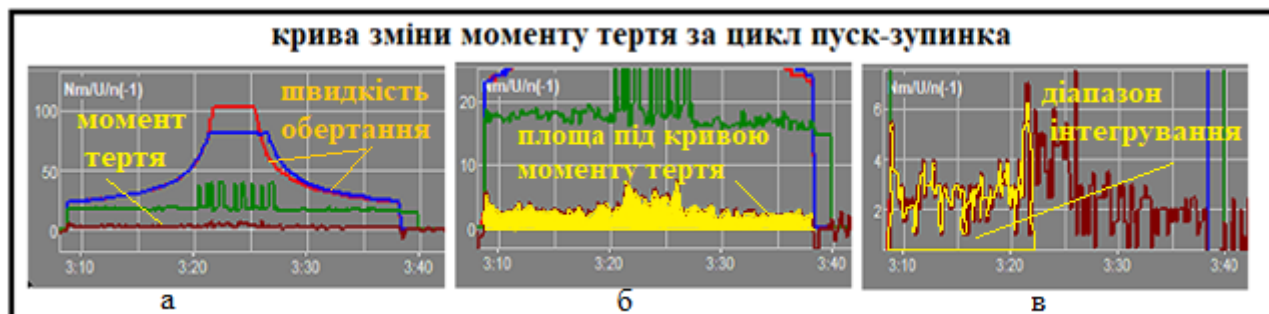
Рис. 2.10. Реєстрація моменту тертя в реальному часі.
