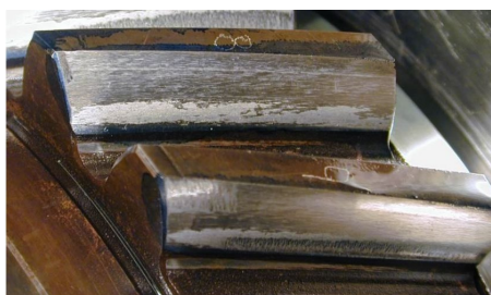
Рис. 1.6. Мікропітинг шестерні (сіре забарвлення) від контактної втоми [67].
