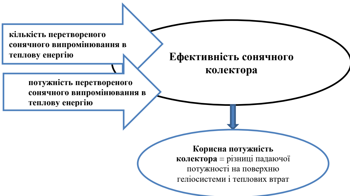
Рис. 3.3. Основні фактори впливу на ефективність сонячного колектора
