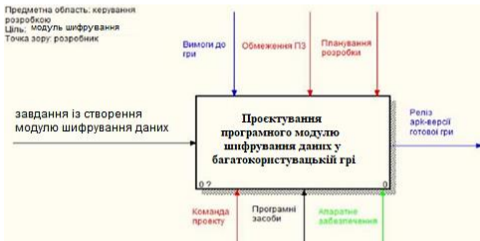
Рис. 4.3. Контекстна діаграма А-О, що описує черговість дій при створенні програмного модулю шифрування даних у багатокористувацькій грі
