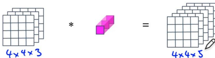
Рис. 2.11 Результат глибинної згортки та перехід до точкової згортки.
