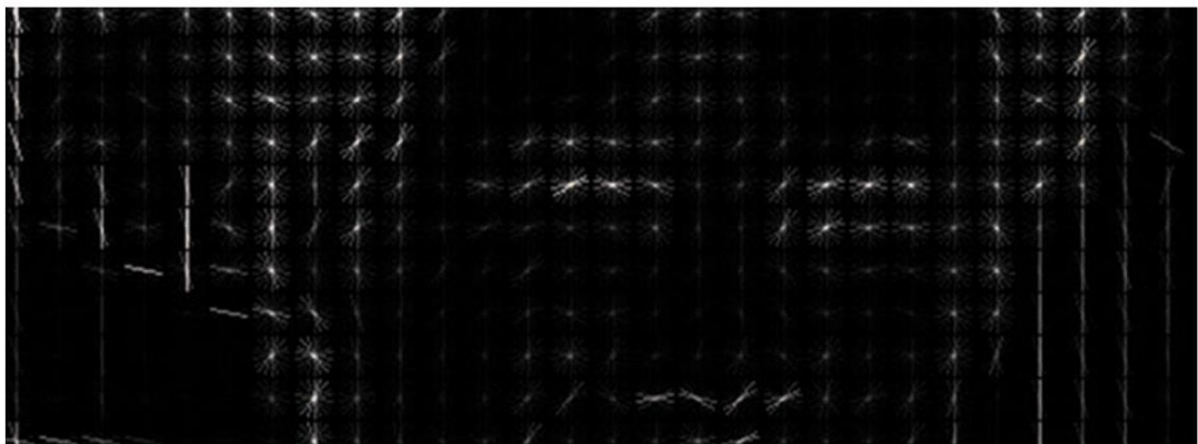
Рис. 2.3 Процедура поділу зображення на блоки 16 \times 16 пікселів і визначення напрямків градієнта
