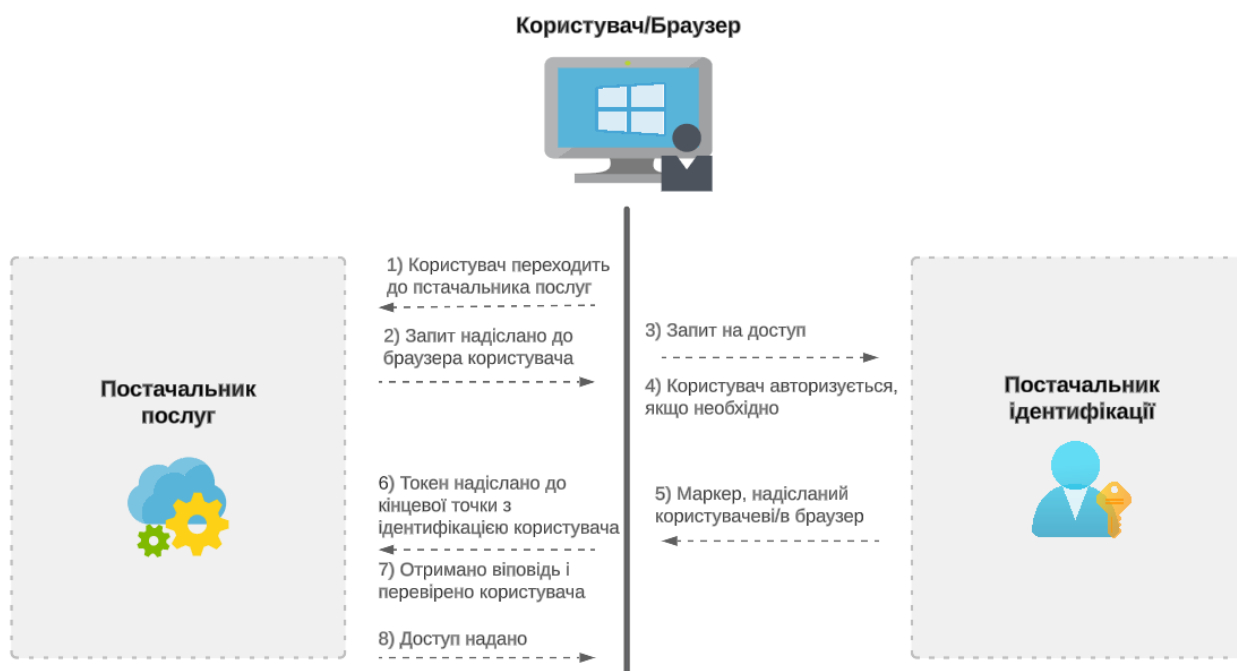
Рис. 1.4. Схематичне зображення принципу роботи SSO
