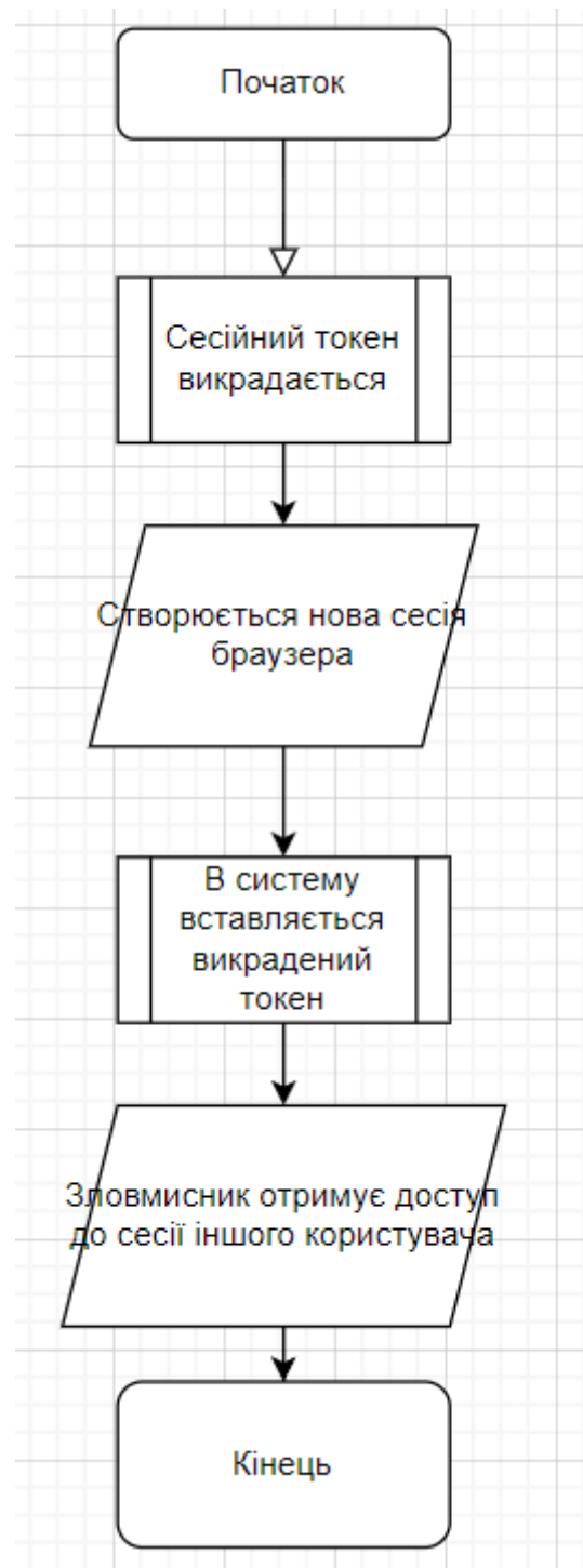
Рис 3.6. Приклад алгоритму атаки фіксації сесії
