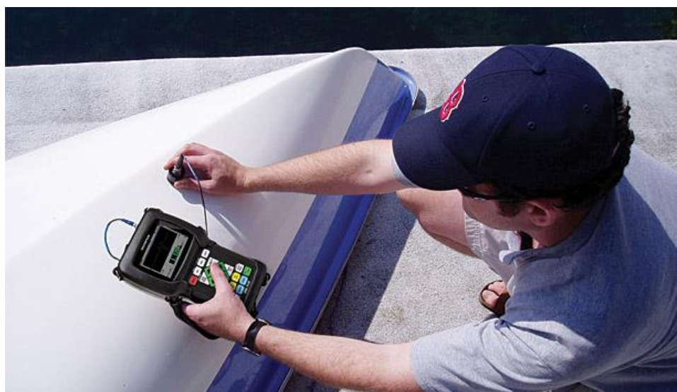
Рис. 2.6. Прилад для ультразвукового контролю композитних матеріалів.
