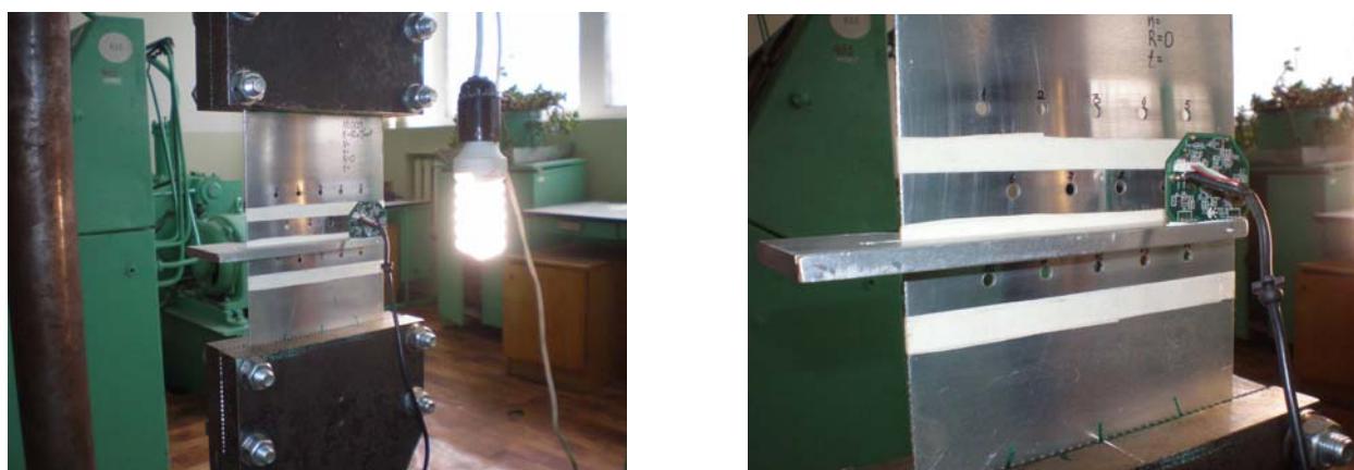
Рис. 2.8. Установка цифровой камеры Logitech QuickCam E3500 на образце
