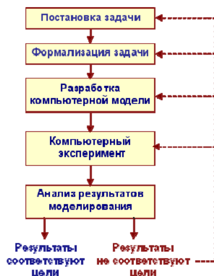
Рис. 4.10. Основные этапы компьютерного моделирования методом Монте-Карло
