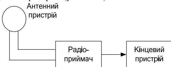
Рис. Б.2.1. Функціональна схема радіопеленгатора
