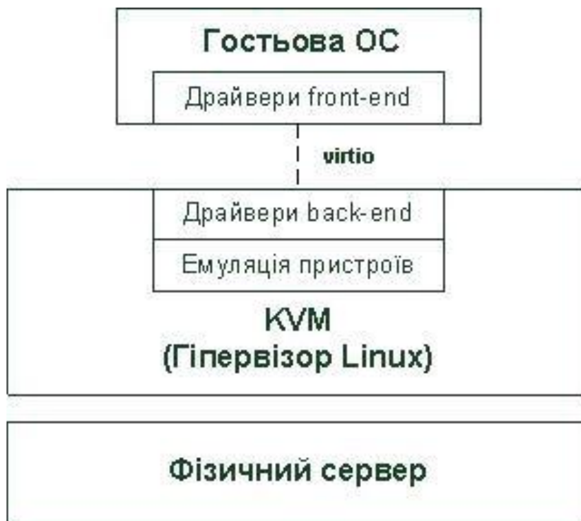
Рис. 1. Структура роботи пристроїв virtio
