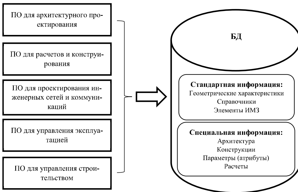
Рисунок 1. Общий вид БД информационной модели здания
